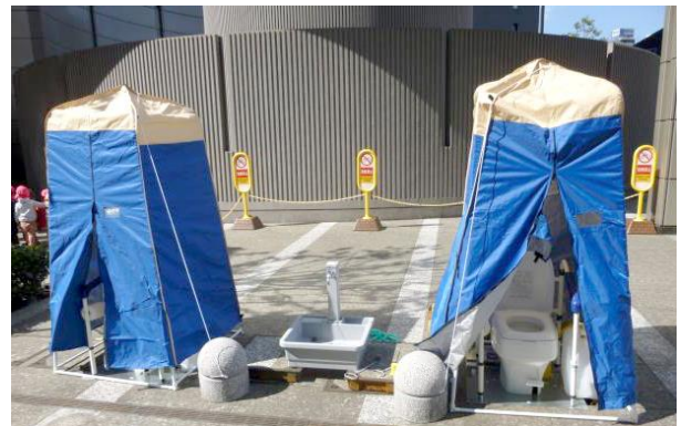
防災トイレの設置（西地区）
