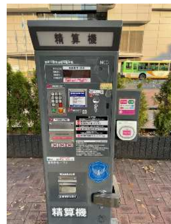
図 88 交通系 IC カード利用が可能な駐輪場精算機
