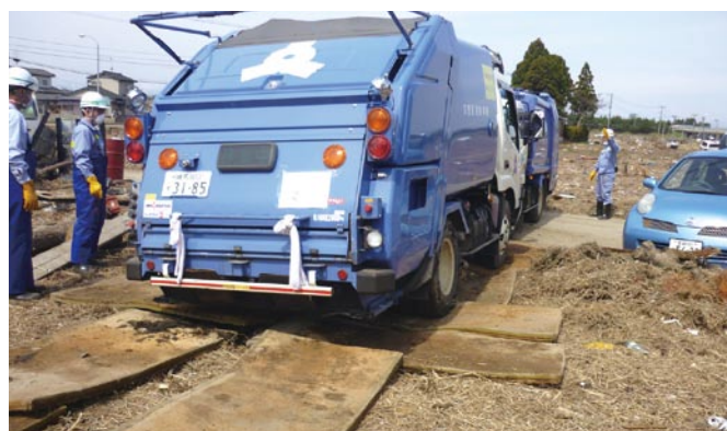
●作業の様子。右の写真は津波等で地面が不安定なため、使用できなくなった畳を敷いて通路を確保している。
