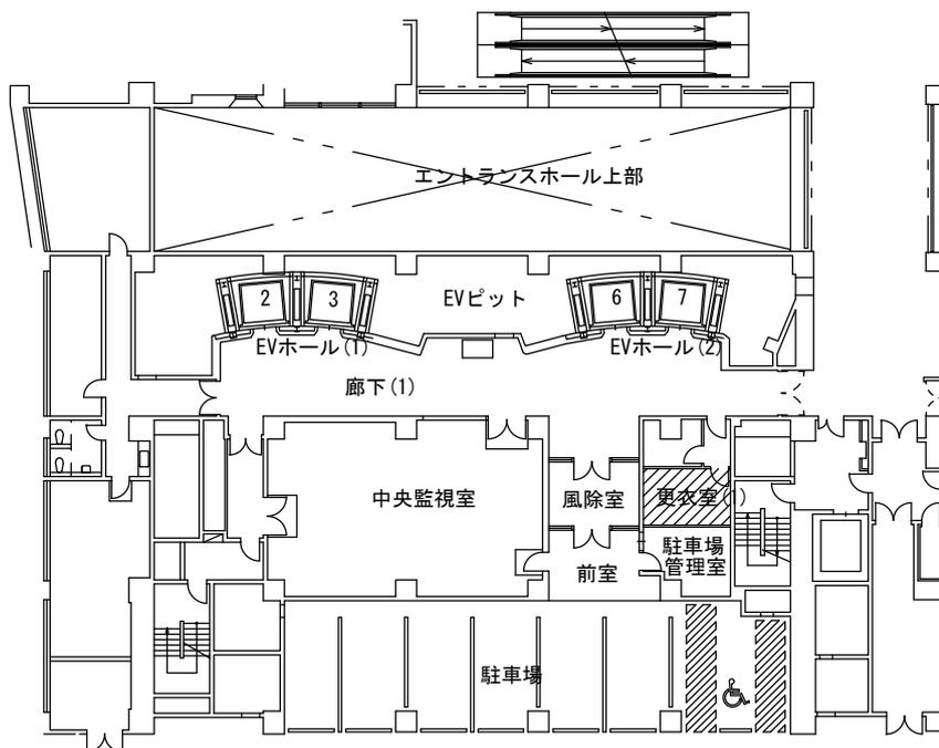
地下1階平面図 (別紙2拡大)
