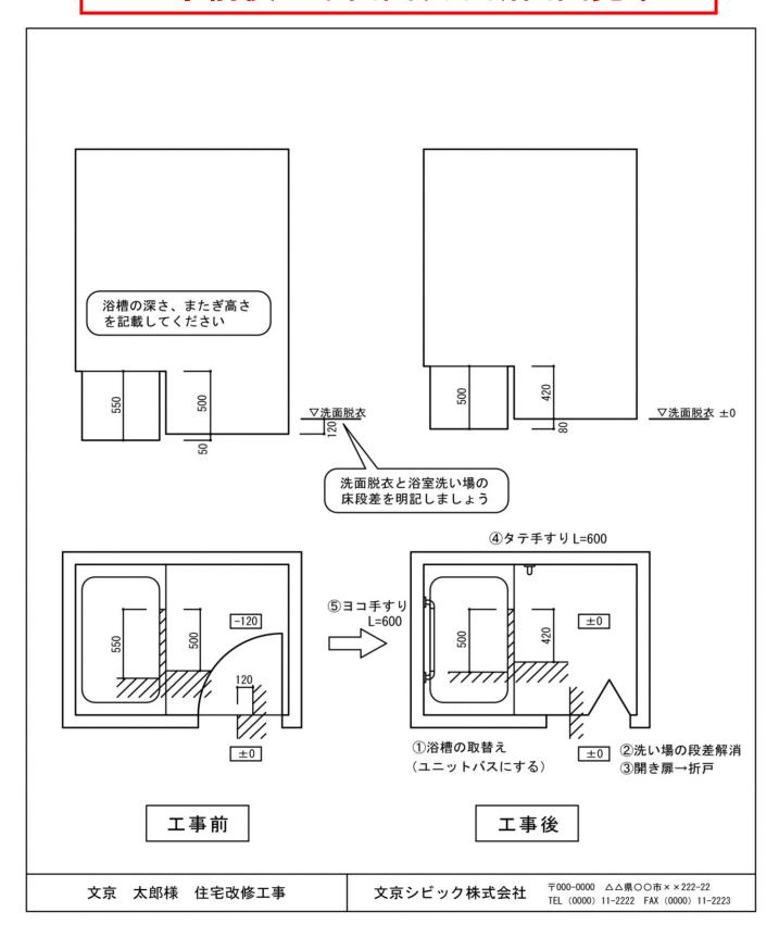
段差のある部分の改修については、工事前後の高低差が分かるように明記します。 洗面脱衣から浴室洗い場との床の段差、またぎ高さ、浴槽の深さなど
