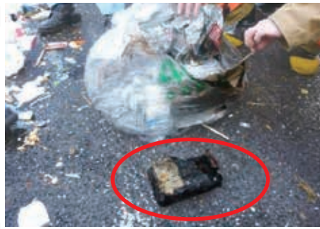
▲可燃ごみの中に混ざり発火した小型充電式電池
