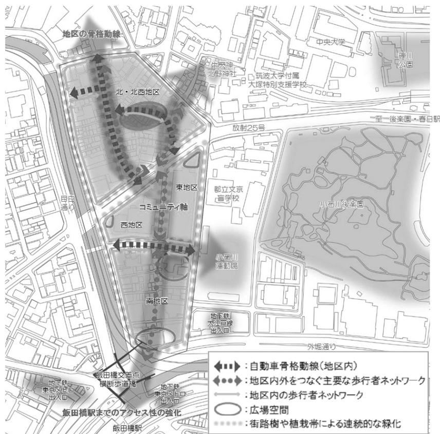
飯田橋周辺 地上・歩道橋レベルの基盤再整備構想図（飯田橋駅周辺基盤再整備構想より）
