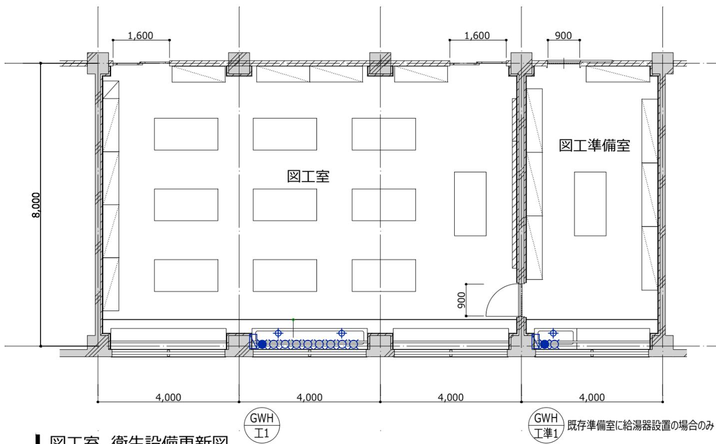
図工室 衛生設備更新図
