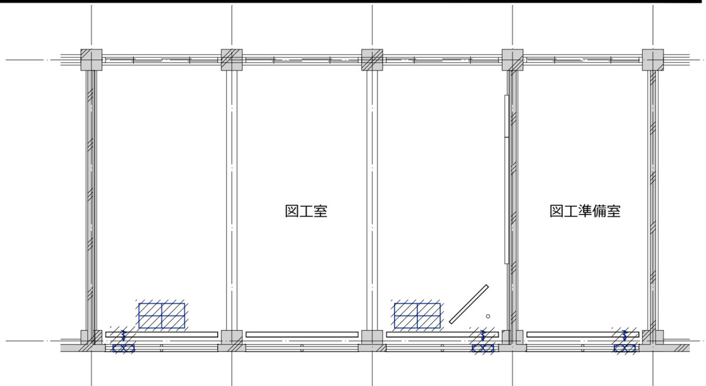
図工室 空調設備撤去図
