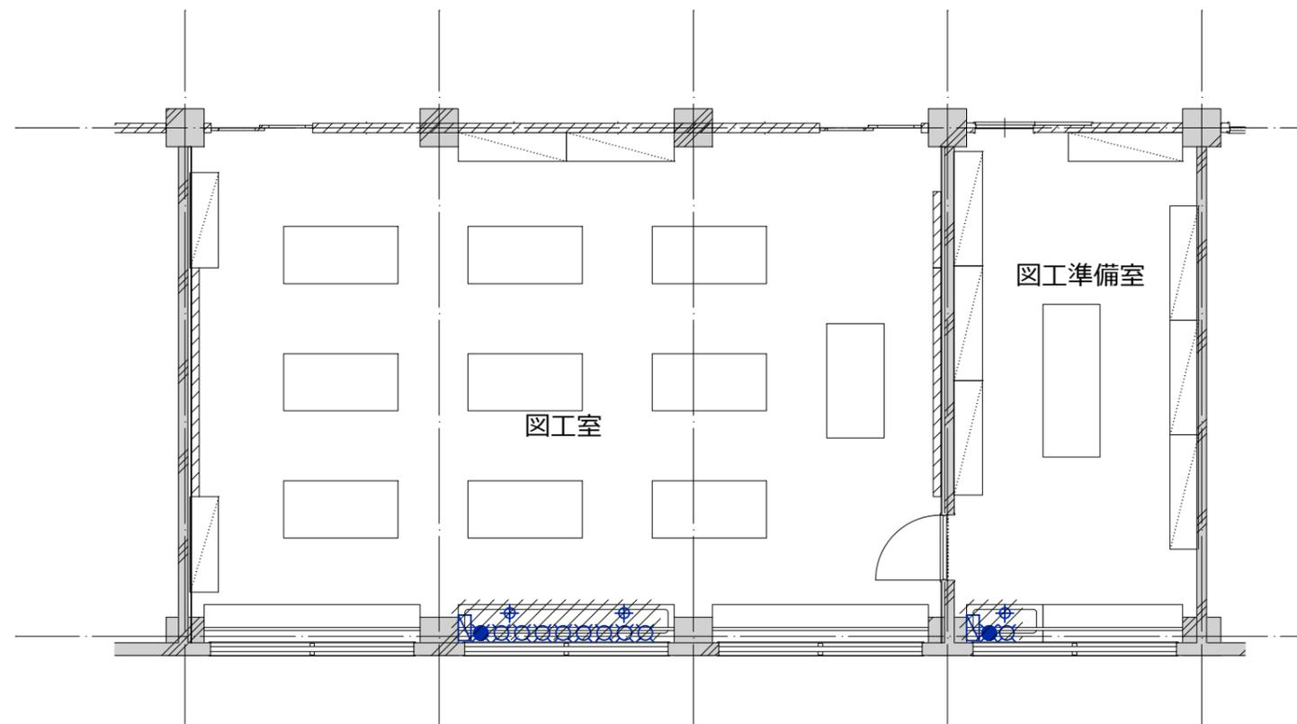
図工室 衛生設備撤去図
