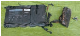
▲車両火災の原因となった「小型充電式電池」
